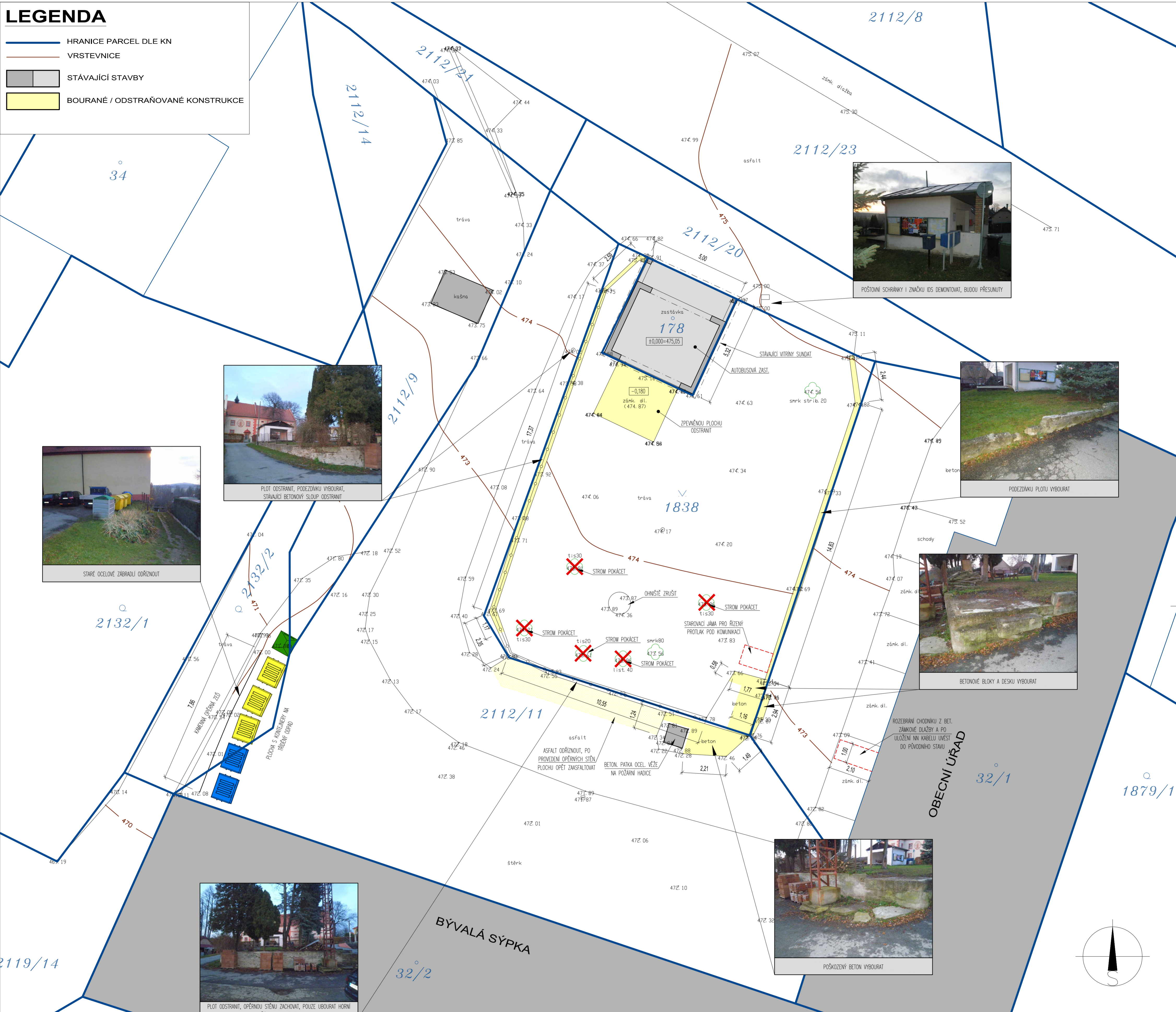
PLOT ODSTRANIT, OPĚRNOU STĚNU ZACHOVAT, POUZE UBOURAT HORNÍ ČÁST cca 300mm
